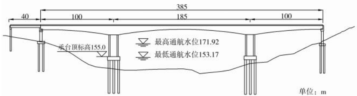
图1 主线红水河特大桥布置图
