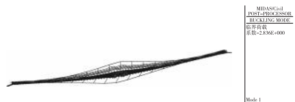
图9 工况 3 全桥整体第一阶失稳模态图( \lambda = 2.836 )
