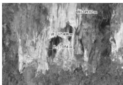
图1 基于倾斜摄影技术的溶洞信息采集过程图
