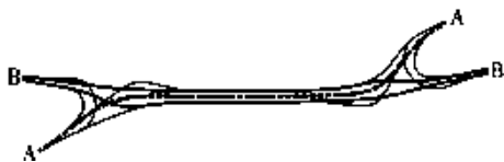
图3 共用路段长度 \leq 3 km时的设计示例图(内侧)
