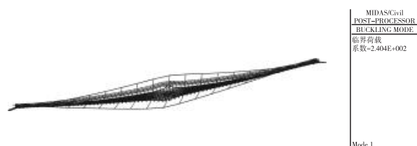
图7 工况 1 全桥整体第一阶失稳模态图( \lambda = 240.4 )
