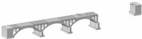
图2 典型施工阶段示意图(阶段3:拆除第4跨)
