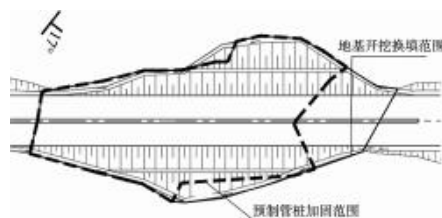
图4 方案一采空区处治平面图
