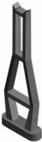
图 1 桥塔大体积混凝土瞬态热分析模型图
