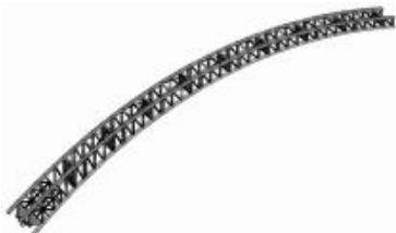
图1 平南三桥主拱肋结构三维图
