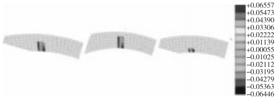
(a) 工况 1 (b) 工况 2 (c) 工况 3 图 4 不同工况下裂纹扩展云图
